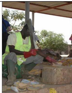
Image 7 : Le découpage des déchets plastique avec une scie à mains
